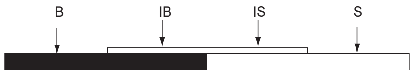
Slika 2: Štiri mesta vrednotenja kot osnova za izračun (S - nepotiskana podlaga; IS - podlaga, potiskana z barvo; B - črno potiskana podlaga; IB - bela barva na črni podlagi).
