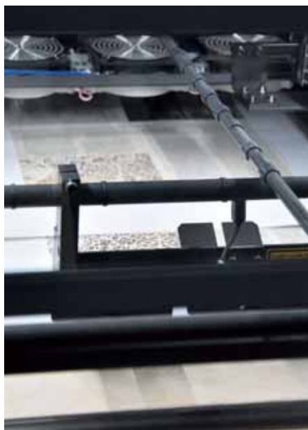
Visoko hitrost tiska profesionalnih produkcijskih strojev zagotavlja zračno voden tek papirja.
